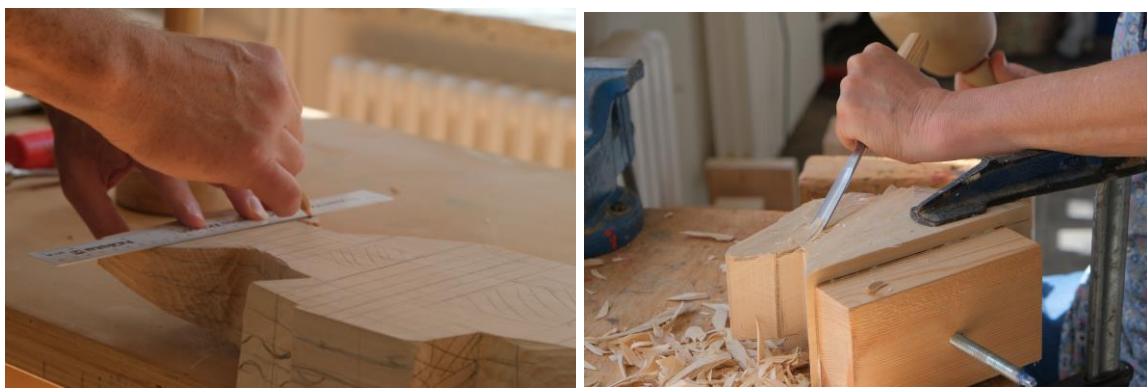
Zwei Bilder zeigen am Holz arbeitende Hände. Einmal wird eine Form angezeichnet, einmal mit einem Stechbeitel und Klüpfel ein am Tisch mit Schraubzwingen festgemachtes
