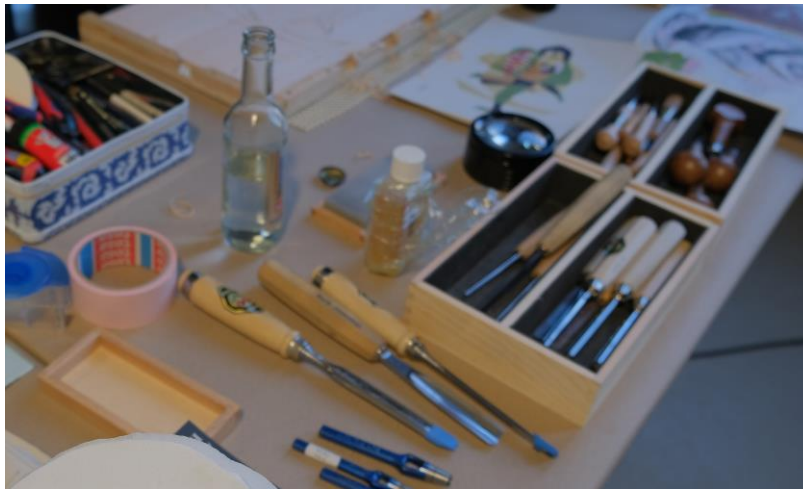
Das Bild zeigt Werkzeuge für Holzschnitt, Schnittmesser und Beitel in unterschiedlichen Größen.
